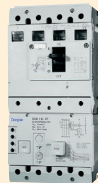
Interrupteurs différentiels de type B sous boîtier moulé de 100 à 250 A, en version 30mA ou réglable de 0,3 à 1A
