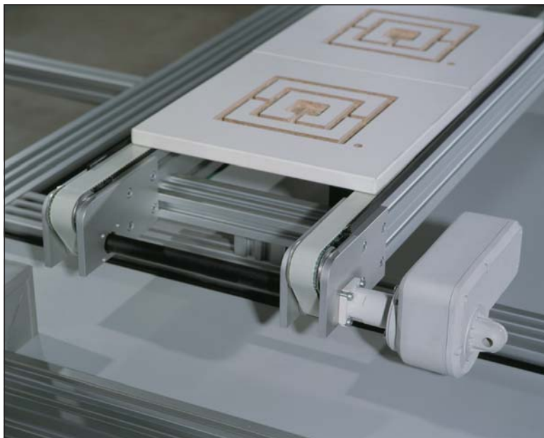
Système de transfert: entraînement de l'alimentation de matériel Transfersysteem: Aandrijving van een materiaaltoevoer
