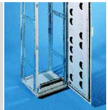
Système de guidage d'air L'air froid introduit par l'ouverture du fond est conduit à travers le socle et la double paroi de la porte pour une orientation ciblée sur les points chauds.
