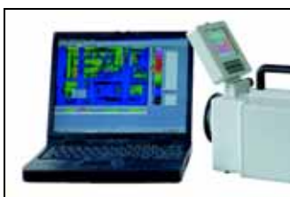
Localisation des points chauds par thermographie.
