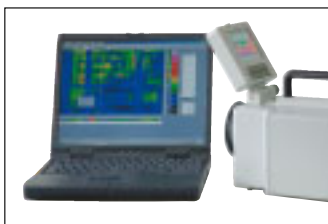
Localisation des points chauds par thermographie.
