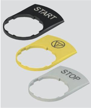
Plaquettes pour dispositifs simples de la ligne EROUND, orientables de 90° en 90°. Disponibles en noir, gris et jaune ; le marquage est gravé au laser directement sur la plaquette. Cela évite d'appliquer des plaquettes supplémentaires ; la description de la commande reste permanente et indélébile pendant toute la durée de vie de la plaquette.
