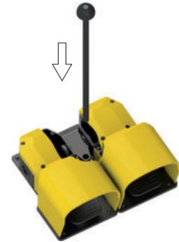
En plus de la possibilité d'assembler deux à quatre pédales simples, les dispositifs d'assemblage permettent d'utiliser un tube en métal pour le raccordement électrique entre les contacts des pédales et les contacts d'un bouton coup de poing d'arrêt d'urgence, relié au même tube, en conservant le degré de protection IP65.
