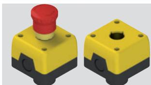
Kit bouton d'arrêt d'urgence, déverrouillage par rotation, conforme à EN 60947-5-1 et EN ISO 13850, à associer à VF KIT31 ou VF KIT29. Degré de protection IP65.
