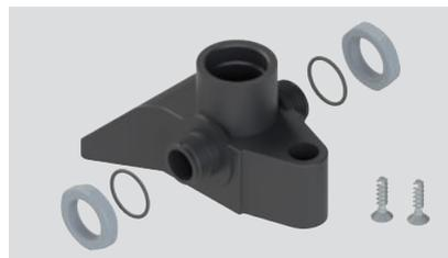
Kit d'assemblage pour pédales en technopolymère avec trou fileté M25x1,5 pour VF KIT31 ou VF KIT29 complet avec écrous, garnitures et vis auto-taraudeuses pour la fixation de deux pédales simples.
