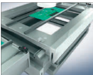
Détection de position finale / capteurs de limites (sans contact) faciles à monter.
