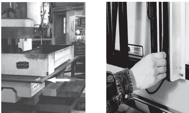
Figure 48 : Bourrelet sur plateau de machine et porte électrique
