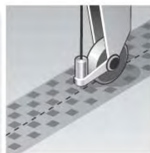
Guidage de lame par un fil métallique, par ex. pour la découpe de textiles.
