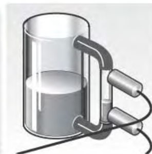
Pilotage de l'arrivée de liquide ou de la pompe sur des réservoirs à eau.
