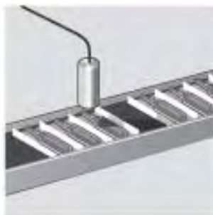
Installations de conditionnement. Ampoules au complet?*
