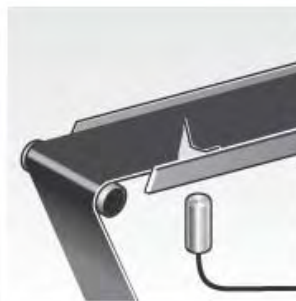
Inspection de bandes de papier, tissu ou film plastique, détecteur au-dessous ou au-dessus.*
